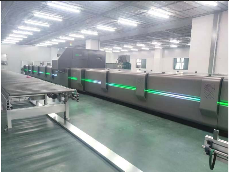
图 2-4 EBP-200-1510 型低能电子束辐照装置外观图
